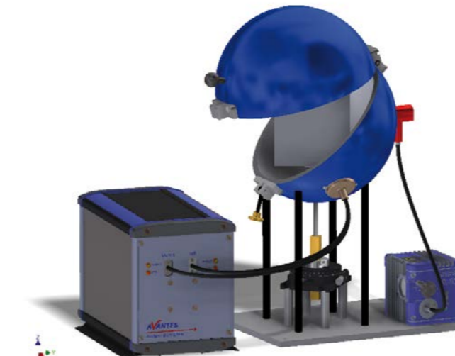
Links: Ulbricht-Kugel zur Messung der Reflexion, rechts: Beispielmessung zweier Wandfarben
