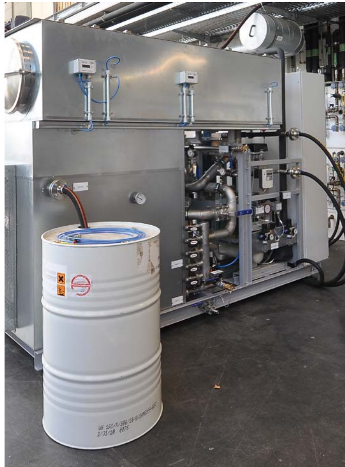
Technikumsanlage für die thermische Aufbereitung von Bilgenwasser
