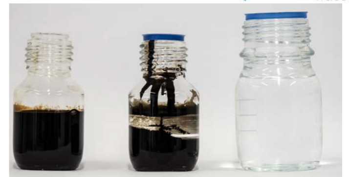
Oben: Anlagenschema einer solaren Meerwasserentsalzung. Unten: In der Mitte der Ausgangsstoff Bilgenwasser, links die gewünschte reine Ölphase und rechts reines Wasser
