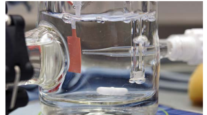
Die Kupferelektrode befindet sich im Kathodenraum. Hier wird das CO 2 gasförmig eingeleitet und das Arbeitspotential gemessen.
