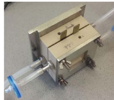
Links, Schema einer Mikrobiellen Brennstoffzelle zur Herstellung elektrischer Energie und Wasser; rechts, Aufbau am ZET
