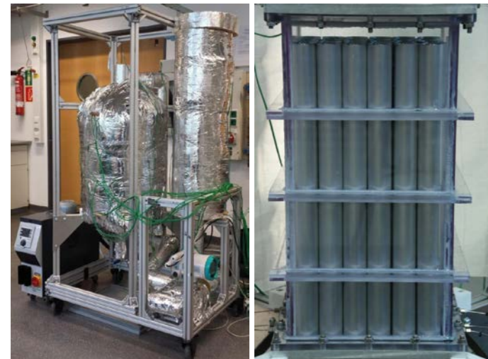
Latentwärmespeicher mit Makrokapseln mit Wärmedämmung (links) und ohne Wärmedämmung (rechts)
