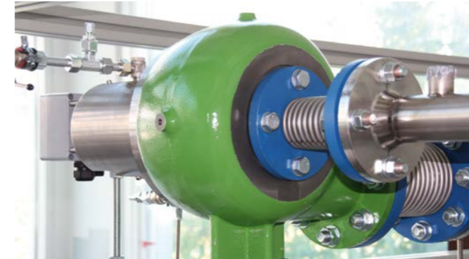
Eine neuentwickelte Mikro-Turbinengeneratoreinheit der Deprag Schulz GmbH im ORC-Testfeld des ZET.
