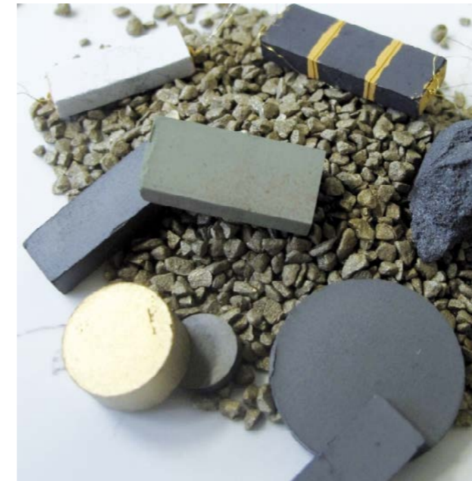
Verschiedene Formen synthetisch hergestellter thermoelektrischer Materialien
